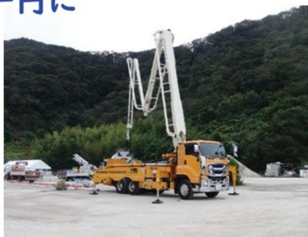
コンクリートポンプ車
