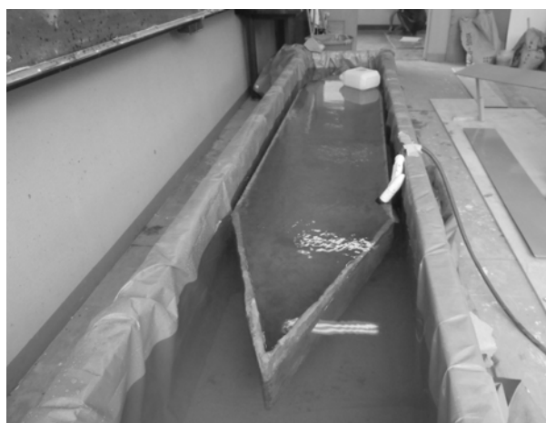
養生用プールにて水中養生を実施中
